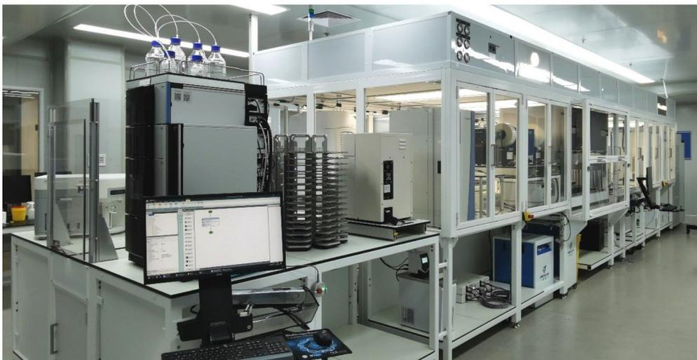
研究院同时建有自主研发的国内首套、国际先进高通量自动化分子智造科学装置（iChemFoundry），基于该装置可实现对目标分子和材料的智能化设计、自动化合成和高通量表征，并通过结合大数据和机器学习开展 CT-IT 深度融合的方法学研究，实现功能导向的分子材料精准创制。自动化科学装置基于高通量与模块化的设计理念，在自主开发的主控软件控制下，通过轨道、机械臂和移动式双臂协作机器人，整合包括自动化移液工作站、自动化批式合成系统、自动化流动合成系统、自动旋蒸仪、自动过柱机、气相色谱、液相色谱、质谱、微型流动核磁共振等各种合成及表征设备，实现固液全自动转移和配制、高通量低消耗合成、高通量表征和筛选。平台自主研发的分布式模块化控制软件可实现包括批式和流式合成、产物递送、在线表征、数据分析、基于人工智能的优化迭代和方案设计等环节在内的全流程闭环自动化操作。
